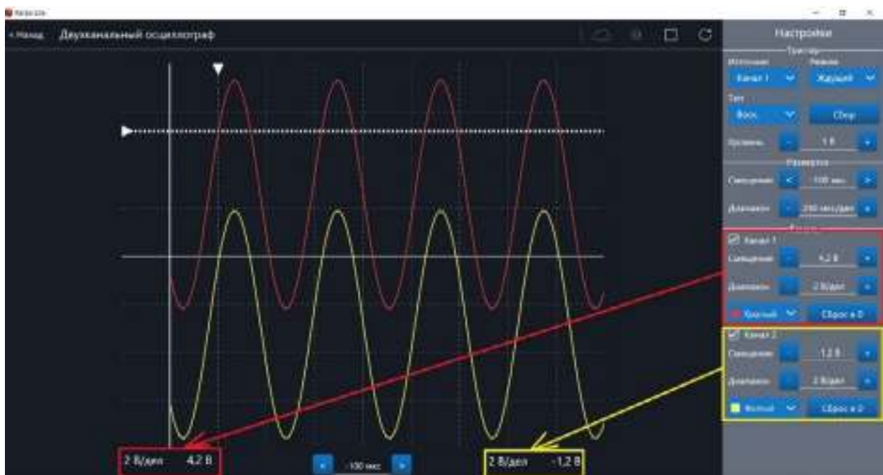
Рис. 39. Использование блока Каналы
