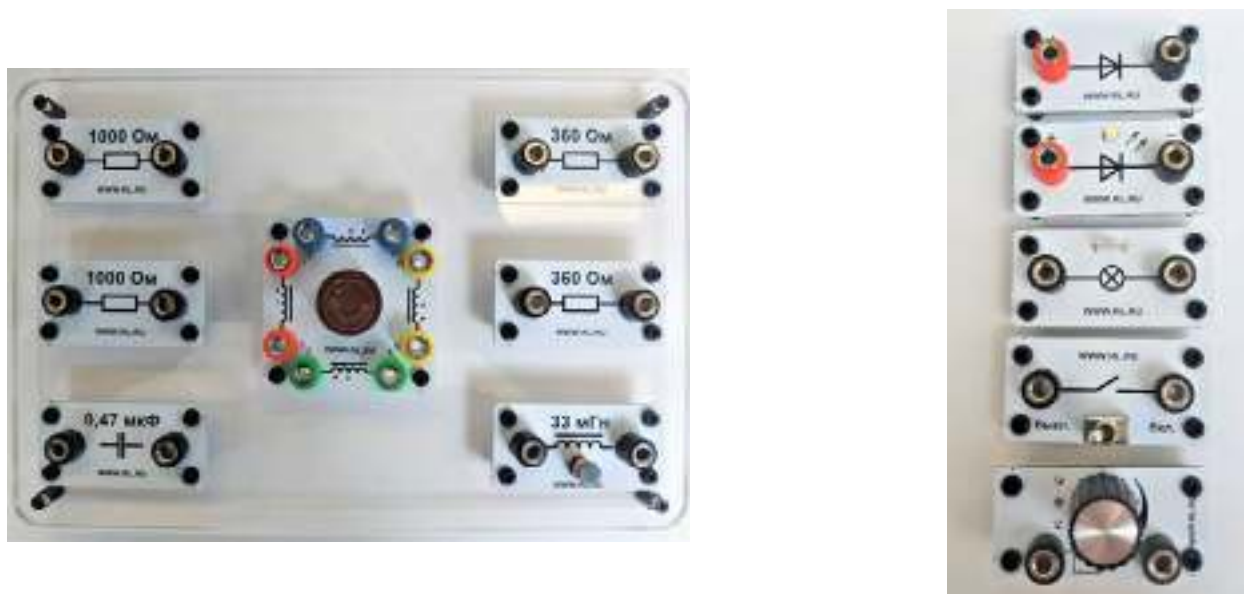
Рис. 17. Дополнительные элементы электрических цепей
